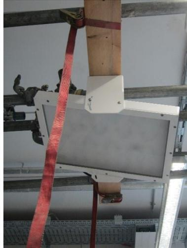
Nach den Ballschüssen konnte eine Schraube von Haltebügel und Strahler nicht mehr entfernt werden. Das ins Gehäuse eingelassene Gewinde drehte sich mit und die Schraube war darin festgefressen.
