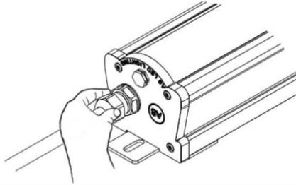
Aussenschraube der IP-Verschraubung aufsetzen und fest anziehen bis die Verbindung dicht ist.
