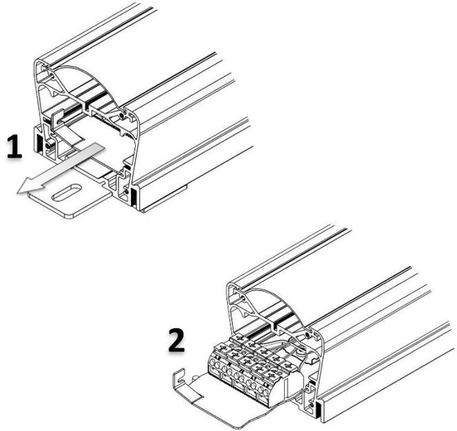
**Netzteilereinheit aus der Leuchte herausziehen
