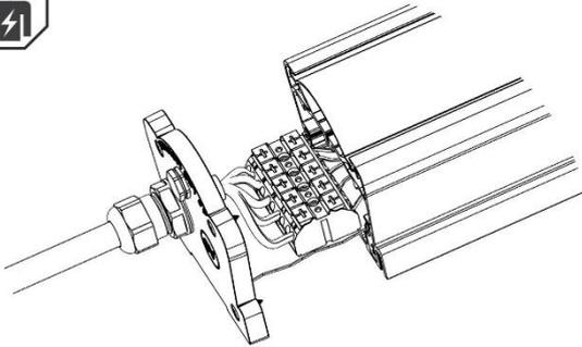
Anschlußkabel gemäß VDE-Installationsvorschrift an der Klemme anklemmen
