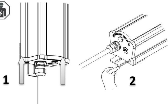
Seitendeckel auf den Leuchtenkorpus von unten nach oben schieben bis er über das Profil rutscht. Anschliessend mit den 4 Schrauben (M4x20) anschrauben. (Torx T20).
