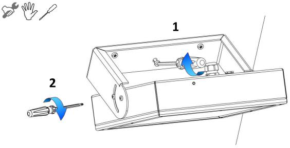
Die Schrauben befestigen (1), dann die seitlichen Schrauben leicht lösen (2) und Korpus in die gewünschte Position drehen.
